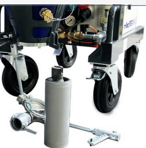
Remplacement rapide de la sortie de pompe grâce aux coins de fermeture.
